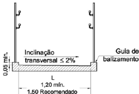
Figura 80 — Inclinação transversal e largura de rampas - Exemplo
